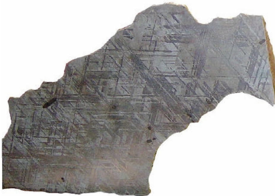
Figure 6 : Plaque de sidérite (météorite ferreuse). La plaque révèle un système de bande entrecroisées, les figures de Widmanstätten, qui correspondent à deux minéraux différents constitutifs de l'alliage fer-nickel, la kamacite et la taénite, qui se sont séparés lors du lent refroidissement du noyau de l'astéroïde-parent (sur des centaines de millions d'années), de même que l'huile et le vinaigre se démixent lorsqu'on les verse ensemble dans un verre.
