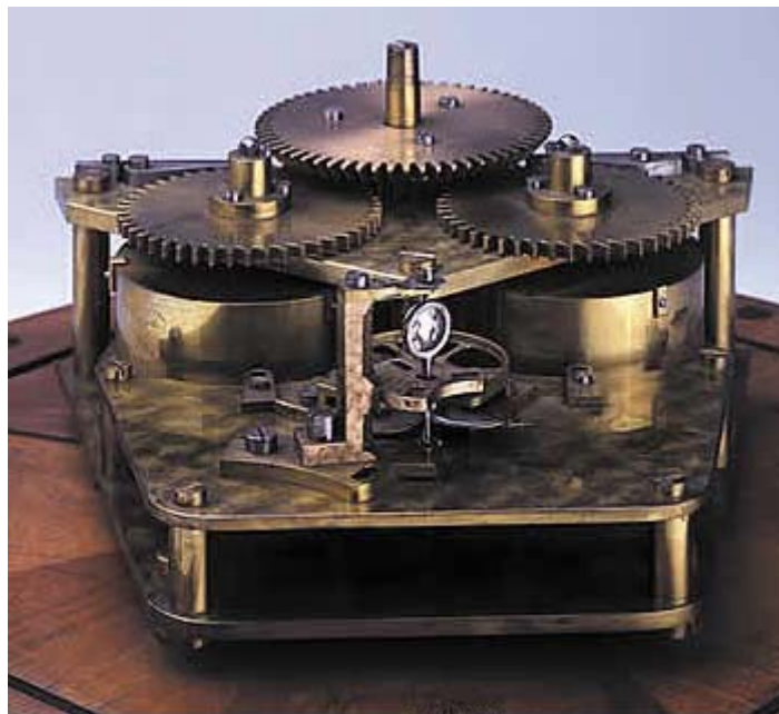
Figure 3 : Le dispositif de rotation d'un miroir mis au point par Bréguet. On reconnaît, au centre de l'image, le petit miroir qui doit tourner à très grande vitesse (500 à 800 tours/s). Louis Bréguet 13 (1803-1883) était à la fois physicien et mécanicien, et conçut ce dispositif horloger pour ce type d'expérience (ici, il s'agit du dispositif utilisé par Fizeau). Comme l'indique Foucault : « La pièce la plus importante et la plus nouvelle de cet appareil était la machine qui devait communiquer aux miroirs le mouvement de rotation. La construction en fut confiée à M. Bréguet, dont le talent garantissait une réussite complète ». (image Observatoire de Paris, site www.foucault.science.gouv.fr )
