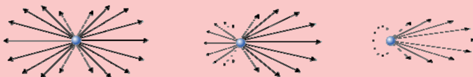
Figure 2 : À droite, cas général de la diffusion de Mie pour un rayon arrivant de la gauche, et une particule de dimension non négligeable par rapport à la longueur d'onde de la lumière incidente. À gauche, cas limite dit de diffusion Rayleigh pour une particule négligeable par rapport à la longueur d'onde.
