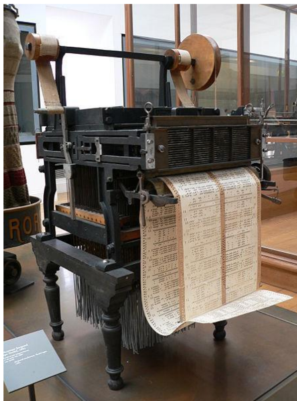
Figure 6 : (en haut) Métier Jacquard avec son système d'instructions par cartes perforées (Musée des Arts et Métiers, photo David Monniaux WikiCommons) ; (en bas) Carte perforée à 80 colonnes, opérant l'instruction informatique figurant en
