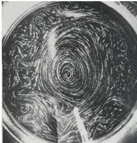
Figure 9 : Expérience de la poêle tournante, du type de celles menées par Dave Fultz et son équipe dans les années 1950. La différence thermique entre le bord chauffé et le centre refroidi crée des mouvements, qui par rotation acquièrent un caractère circulaire – mouvements très similaires à ceux du flux atmosphérique à la hauteur des avions, à 9-12 km d'altitude.
