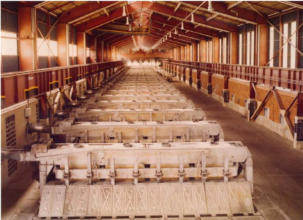
***Figure 7 : Série de cuves d'électrolyse de 175 000 ampères de l'usine Pechiney de Saint-Jean-de-Maurienne, démarrée en 1979.***
