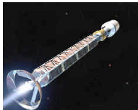
Figure 12 : Fusée à propulsion d'antimatière. À gauche, le schéma du moteur. L'antimatière, injectée dans la chambre de combustion, s'annihile avec une partie de l'hydrogène présent et produit une grande quantité de chaleur. L'hydrogène restant est éjecté à haute vitesse et assure la propulsion. Une petite fraction de l'hydrogène est canalisée par le conduit de déviation, passé par une turbine qui entraîne une pompe nécessaire à la circulation de l'hydrogène. Ce dernier est injecté dans l'enveloppe du moteur où il est réchauffé, arrive dans la chambre d'entrée, passe dans la matrice
